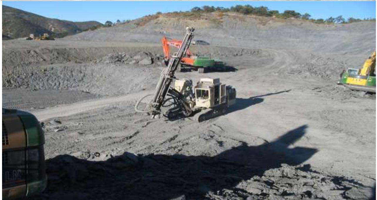
Notre équipe de minage effectue 200 000 M<sup>3</sup> de tir par an, ainsi que du pré-découpage pour chantier et des trous pour des parois cloutées.
