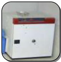
**Teneur en eau** : Permet de déterminer la quantité d'eau contenue par les agrégats. Elle se fait par un séchage en étuve ventilée (à 110°C) et se traduit par un pourcentage.
