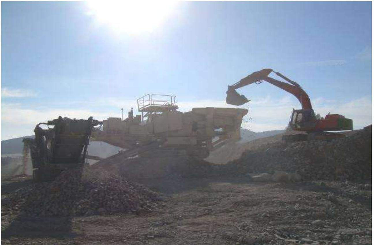
Un concasseur primaire à mâchoire LOKOTRAC 125 suivi d'une cribreuse.
