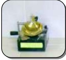
**Indice de plasticité ou limite d'Atterberg** : Permet de mettre en évidence la plasticité d'un sol par la détermination de sa limite de liquidité et sa limite de plasticité en faisant varier la teneur en eau de l'échantillon. Elle se traduit par un indice.
