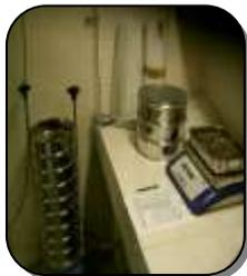
**Granulométrie** : Permet d'étudier la répartition de la taille des grains. Elle se fait par tamisage d'un échantillon prélevé par sondage pour les agrégats de taille supérieure à 0,063 mm Elle se traduit par une courbe.
