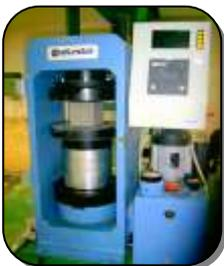
**Essai à la compression** : Permet de contrôler la résistance des bétons une fois durcis. Il se traduit par l'exposition des éprouvettes cubiques (ou cylindriques) à une force par compression.
