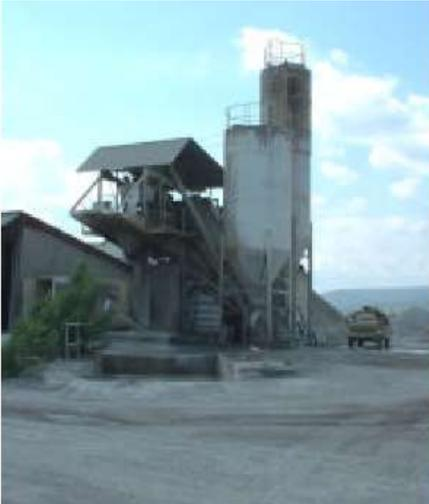
La centrale à béton de Manosque produit en moyenne 25 000 M<sup>3</sup> de béton par an avec une capacité maximale de production annuelle de 40 000 M<sup>3</sup>.
