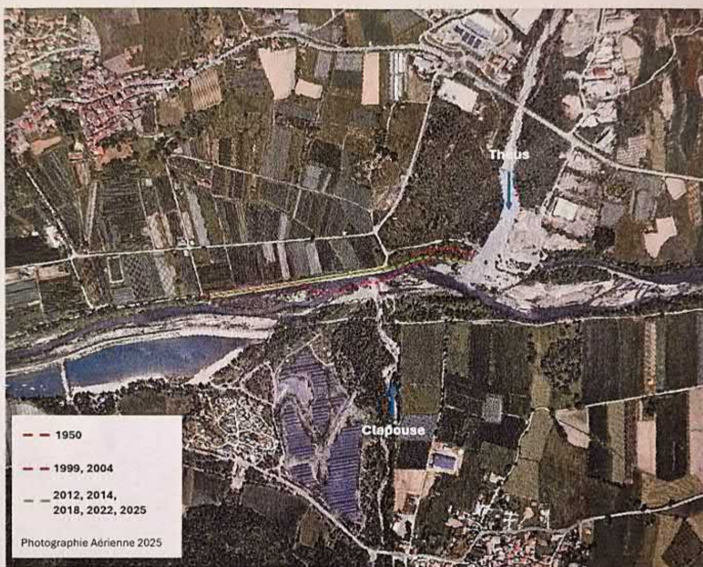
Figure 5: Evolution du trait de berge au fil du temps au niveau de la digue de Remollon
